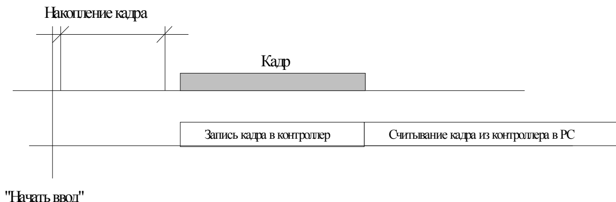
Рис 6. Циклограмма захвата изображения в контроллер при программном запуске ввода изображения.
