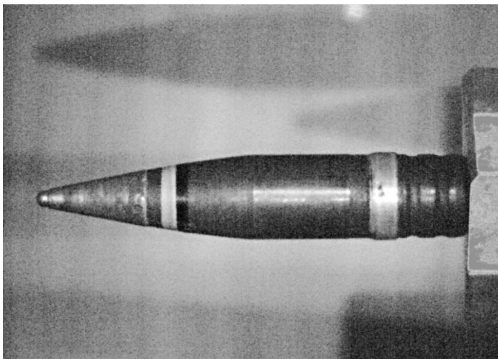
Рис.7. Изображение 30 мм снаряда, полученное камерой ВИДЕОСКАН-285 с расстояния 1,5 м со времени экспозиции 130 нс и относительном отверстии объектива 1:1,8 при подсветке четырьмя устройствами подсветки ВидеоСвет.
