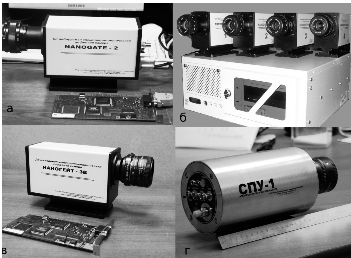
Рис. 3. Камеры серии НАНОГЕЙТ: а) электронно-оптическая камера НАНОГЕЙТ -2 с контроллером ввода изображения в компьютер. б) многокадровый электронно-оптический комплекс НАНОГЕЙТ-9 (в комплекте с промышленным компьютером. в) двухкадровая электронно-оптическая камера НАНОГЕЙТ -3В. г) универсальная электронно-оптическая камера СПУ-1
